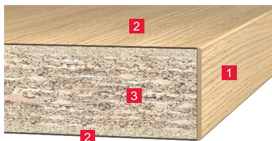
Рис. 11: строение комбинированной плиты, облицованной ДБСП, с кромками АБС компании ЭГГЕР
